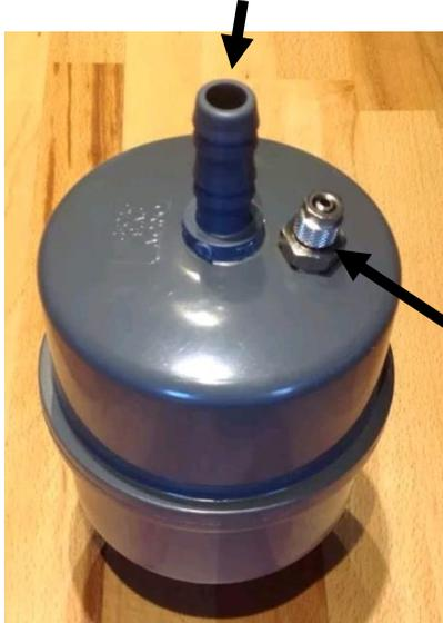
Standardmäßig sollten Sie den Reaktor senkrecht in die Ausgangsleitung der Filteranlage integrieren. Dort, wo vorgefiltertes Wasser ausströmt.
